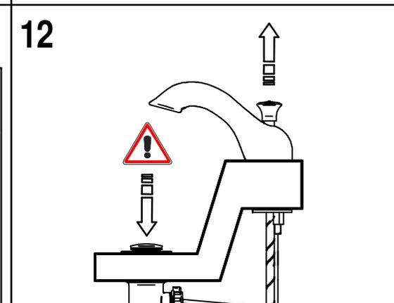
**SOSTITUZIONE VITONE / VALVE REPLACEMENT**
